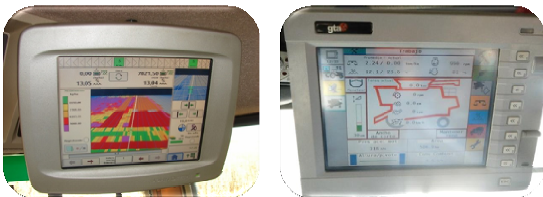
Figura 3: Monitores de rendimiento con información en pantalla utilizada por el operario y que luego quedará georreferenciada en el mapa de rendimiento.
