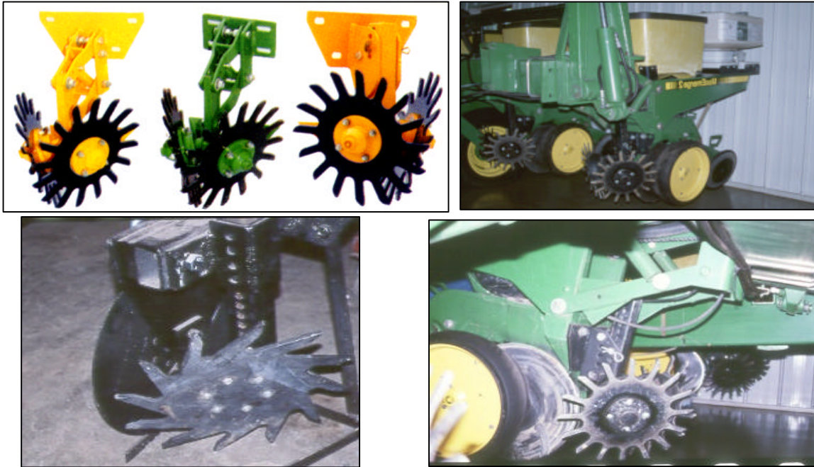
Figs. 4,5,6 y7: diferentes tipos de barredores de rastreo articulados, fijos y su colocación en el cuerpo de siembra.
