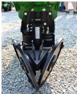
Figura 12. Sistemas controladores de presión en barre rastrojos, a) Air Adjust Floating row Cleaner 2940 de la marca Yetter que forma parte de un cuerpo de Siembra Exact Emerge de John Deere, b) Dawn Floating Row Cleaner, y c) Precision Planting CleanSweep.
