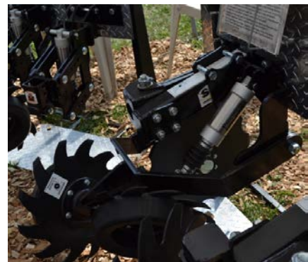
Figura 12. Sistemas controladores de presión en barre rastrojos, a) Air Adjust Floating row Cleaner 2940 de la marca Yetter que forma parte de un cuerpo de Siembra Exact Emerge de John Deere, b) Dawn Floating Row Cleaner, y c) Precision Planting CleanSweep.
