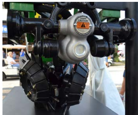
Figura 12. Sistemas controladores de presión en barre rastrojos, a) Air Adjust Floating row Cleaner 2940 de la marca Yetter que forma parte de un cuerpo de Siembra Exact Emerge de John Deere, b) Dawn Floating Row Cleaner, y c) Precision Planting CleanSweep.
