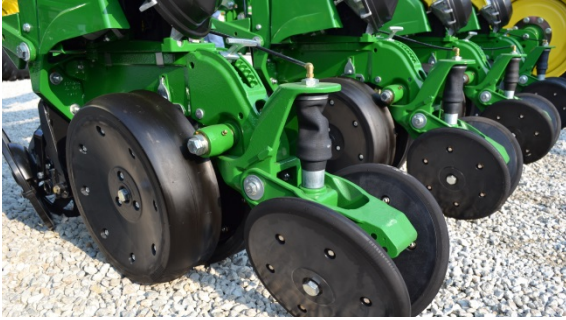
Figura 11. Sistema controlador de presión en barre rastrojos, de la marca John Deere que forma parte de su cuerpo de Siembra Exact Emerge
